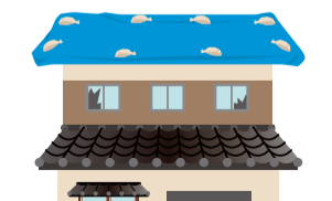
防水シートによる屋根の養生、建物の簡単な補修など
