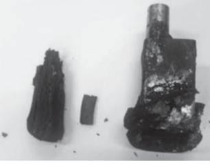
▲変形したリチウムイオン電池
