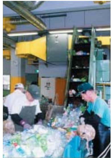
リサイクルセンターでの ペットボトルの選別作業
