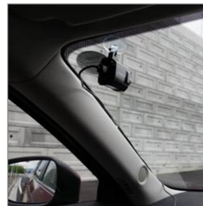
車載カメラによるリアルタイム映像転送
