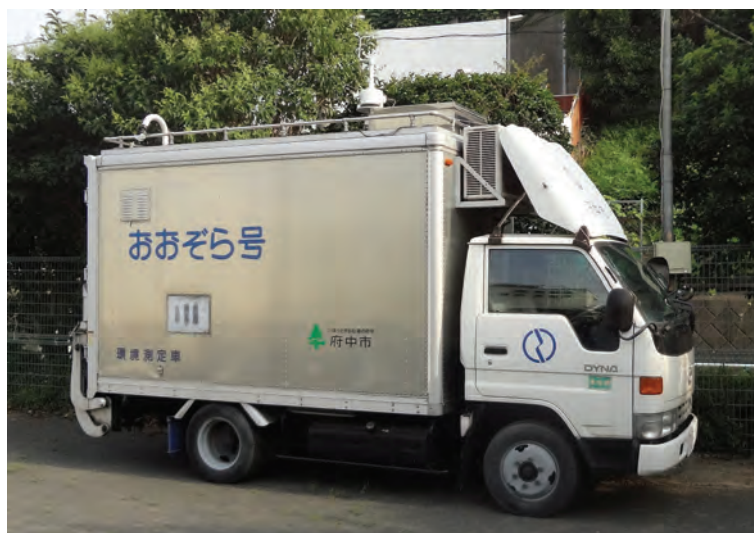
環境測定車での大気汚染物質の監視
