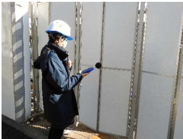
図 4-23 騒音調査の様子
