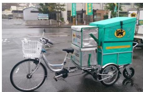
リヤカー付3輪電動アシスト自転車 【出典：ヤマハ発動機(株)、ヤマト運輸(株)】
