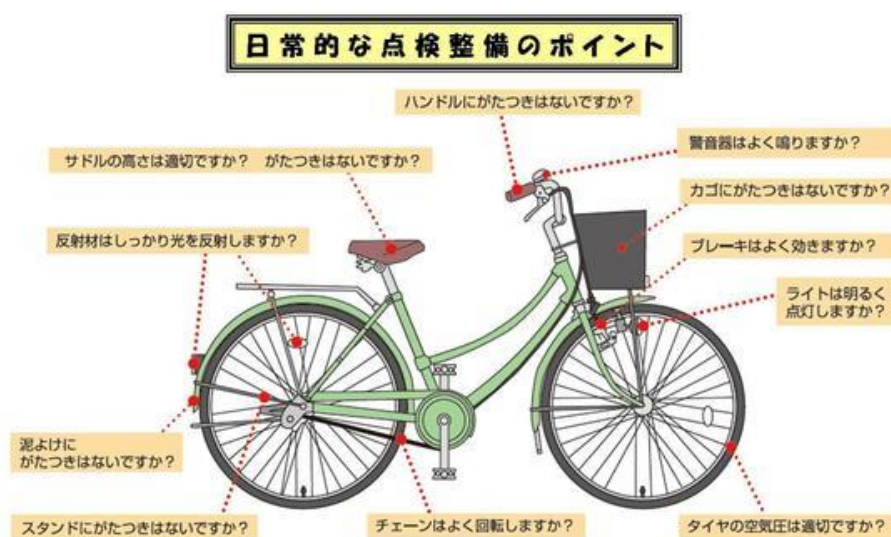
図 4-24 日常的な点検整備のポイント
