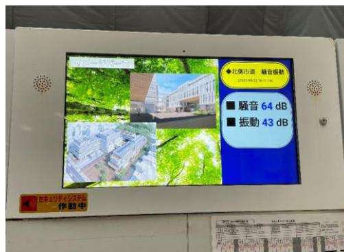
建設現場の騒音・振動レベルの電光掲示板
