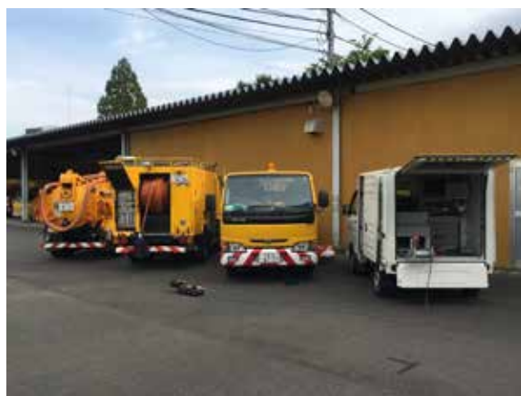
図 4-2 維持管理車両 (左からバキューム車、高圧洗浄車、 作業車、TVカメラ搭載車)
