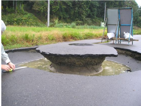
液状化によるマンホールの浮上
