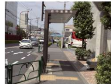
上屋や視覚障害者用誘導用ブロックが設置されたバス乗降場
