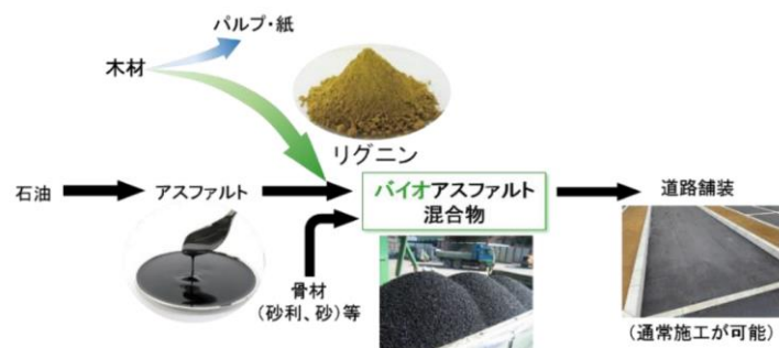
図 4-10 リグニンを利用したアスファルト混合物のイメージ 12)
