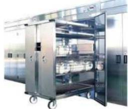
洗浄後の食器をコンテナに積み込んでそのまま消毒保管します。配送時にはコンテナごと運べるので翌朝の食器の積み込み作業がなく効率的です。
