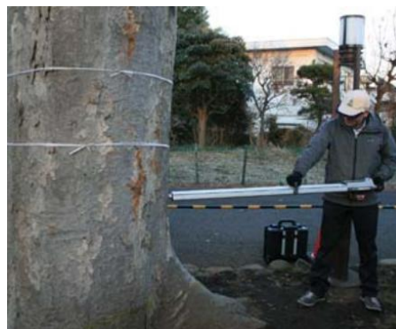
レジストグラフという貫入抵抗値の測定器。 錐（きり）で穴を開けて、内部の硬さの違いで腐食の程度を予測する機器です。
