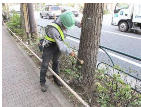
木槌による打音検査の様子。 打診の強さによっては樹皮が傷つくので、必要最小限にとどめます。
