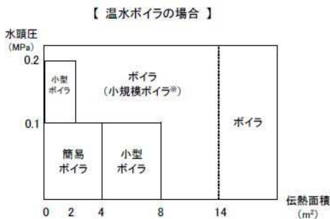
図 4-8 温水ボイラーの法的分類
